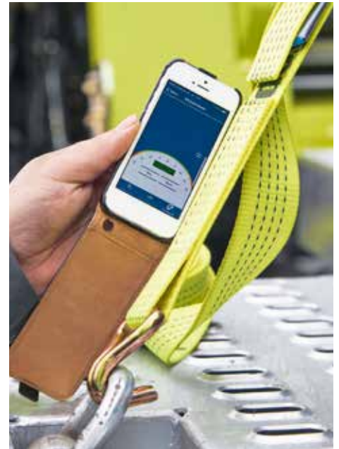
Niederzurren von Betonplatten, Zurr-Rechner
